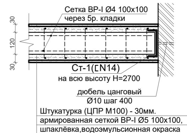
Узел крепления кирпичной перегородки к стене
